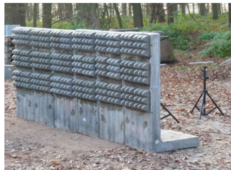
Aplikace obkladových dlaždic na protivýbuchovou zábranu
