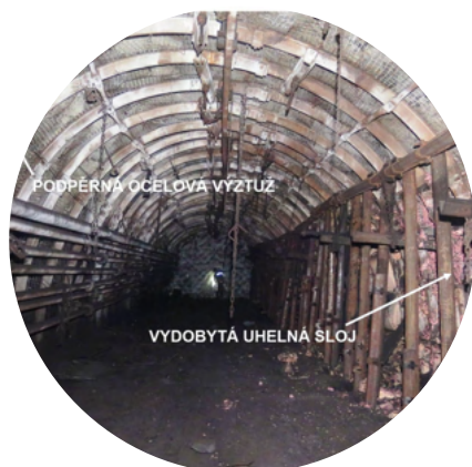
Chodba po vydobytí poruby podél pravé části chodby
