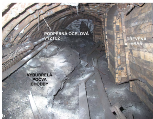
Obr. 1 Příklad dvojího použití porubní chodby před aplikací nové metodiky (a – schéma vyztužování chodby, b – foto chodby po vydobytí porubu podél pravé části chodby).
