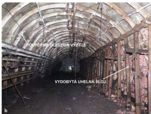
Obr. 2 Příklad dvojího použití porubní chodby po aplikaci nové metodiky (a – schéma vyztužování chodby, b – foto chodby po vydobytí porubu podél pravé části chodby).
