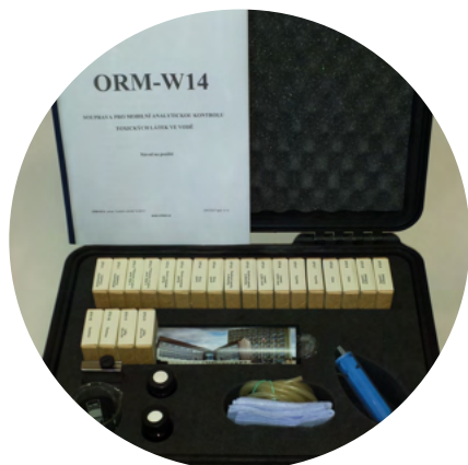
Souprava pro mobilní analytickou kontrolu toxických látek ve vodě
