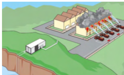
Obrázek 1 Jednoduché čerpání vody s pomocí 1 VKMČ, s jedním či dvěma podávacími čerpadly, pro větší počet zařízení (CAS apod.) – nebo „napřímo“ do proudnic.
