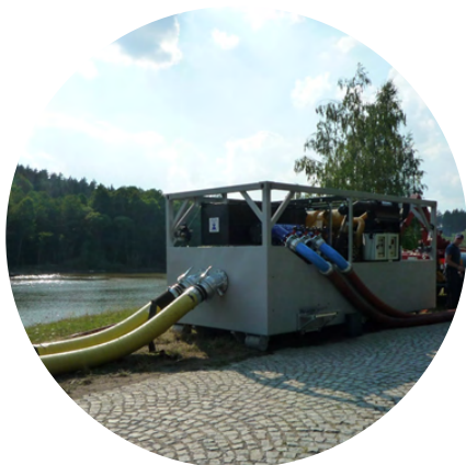
Rozložený VKMČ vzdálený od vodní plochy s předřazenou podávací stanicí
